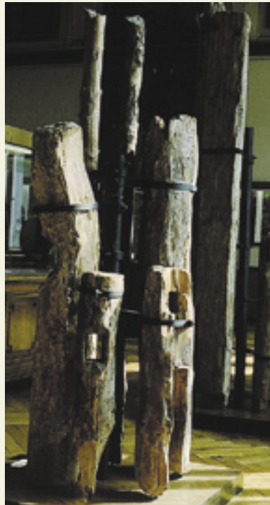
A fatárgyak károsodnak (például repedeznek, görbülnek) ha a nap kiszáritja a levegőt körülöttük
