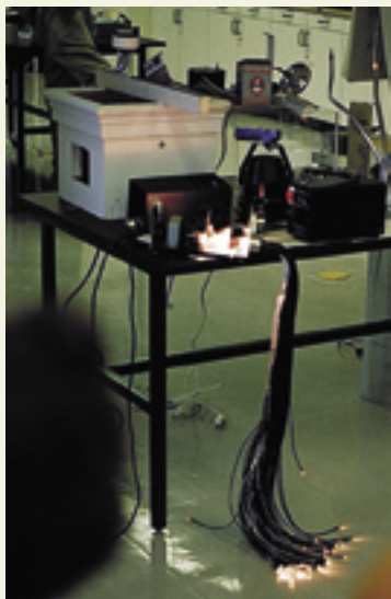
Üvegszál optikás megvilágítás – a fényforrás és a kábelek
