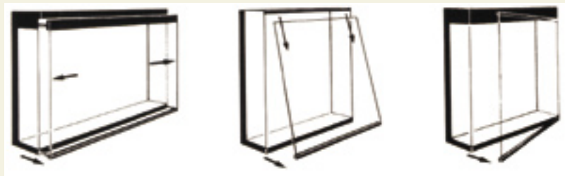
A tolóajtós, levehető falú vagy nyitható ajtós tárlók rendszerint rosszabbul zárnak, a zsanéroknál, zárnál mindig van légcserre
