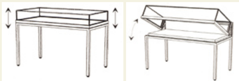
Az éleken ragasztott, üveghasáb tárló és a billentéssel nyitható asztali tárló - tapasztalataink szerint a legjobban szigetelhető vitrin-típusok
