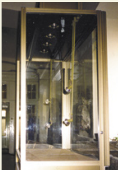
A tárlóba beépített fényforrások felmelegítik a tárló levegőjét, így lecsökken a relatív légnedvesség
