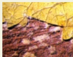
Sókiválás és mázleválás mázas kerámián
