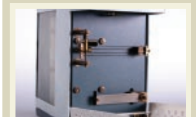
A termo-higrográf nedvesség-érzékelő (felül, szálak) és hőmérséklet-érzékelő (alul, bimetall) része
