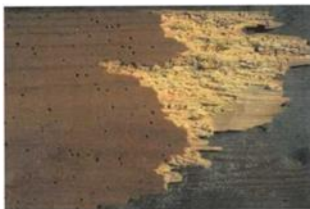
2.49 Ábra Kis kopogóbogár ( Anobium punctatum ) által okozott károsodás
