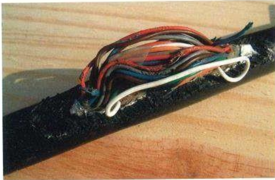
6.5 Ábra Sérült kábel
